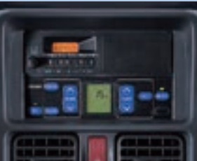
冷凍機コントローラー
